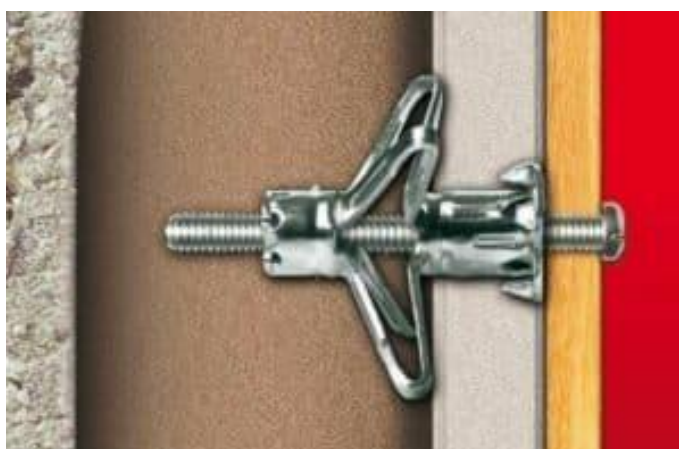
Fonctionnement d'une cheville à expansion Molly
